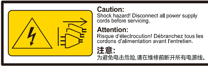
图8-2 多电源安全防护
