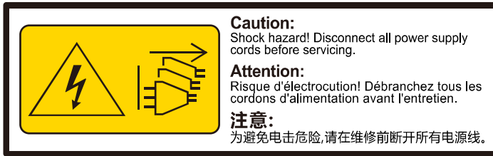
图8-2多电源安全防护
