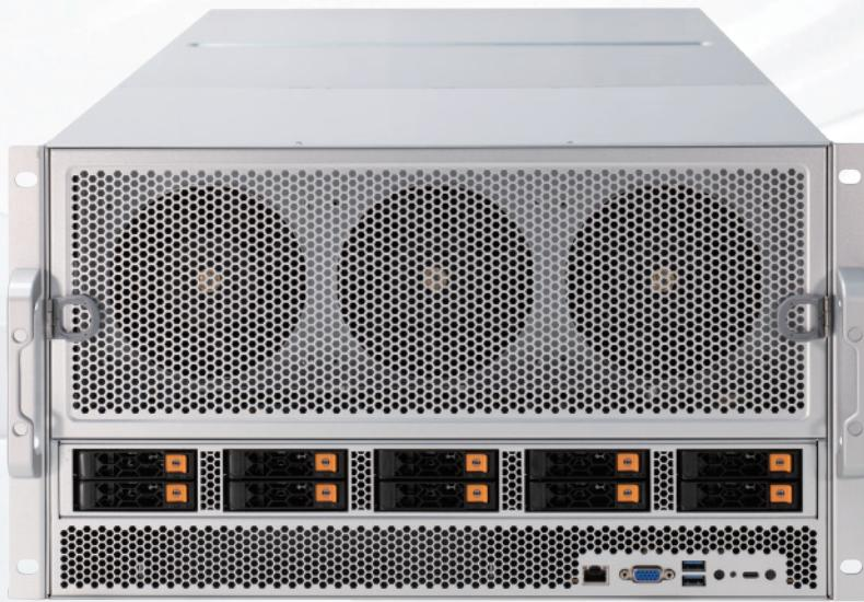
SuperSvr G5208 PCIE5A是四通集团推出的新一代PCIE5.0 6U AI智算服务器产品，采用独特的隔离式分区热管理结构，对于高热量GPU区采用前、中、后三段接力式散热设计，并辅助错位布局有效解决冷空气与热源的接触，实现了GPU卡运行在较低温度，保障了整个系统的运行稳定性与效率。
